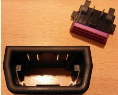
OBD-Buchse aus Halterahmen demontiert
